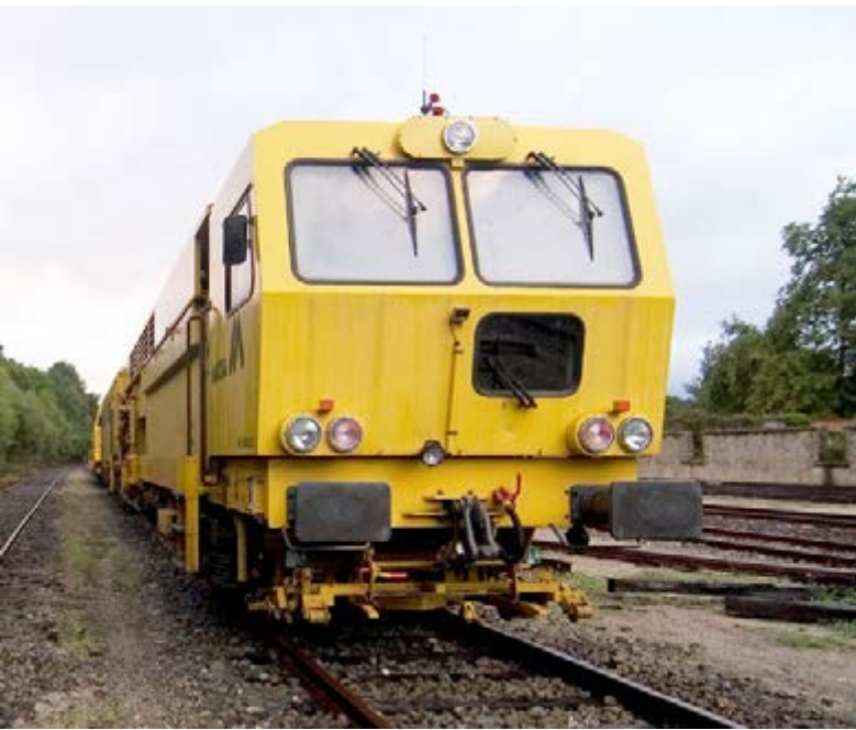
Bateadora MATISA B-66U con bogies para trabajar en líneas de alta velocidad
